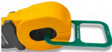
После включения и автоматической юстировки прибор устанавливается в режим измерения сопротивления, на дисплее отображается символ  $0\Omega$ . Нажмите на курок, разомкните зажимы, зажмите входящий в комплект калибровочный контур и считайте значение сопротивления.
