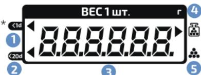
\*-[Недостаточный отбор проб]: вес образца должен быть тяжелее 1d (d=деление), в противном случае стрелка, указывающая на символ недостаточного отбора проб, будет гореть. Весы все еще работают, но счетчик может содержать ошибки.
