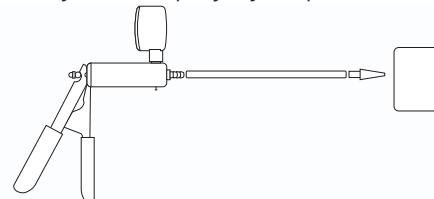
Свободный конец шланга соедините со штуцером вакуумного оборудования. Нажимая на рычаг, создайте разряжение в полости. Осуществите проверку герметичности системы.. Таким же образом осуществляется проверка вакуумных включателей и датчиков. Выравнивание давления с атмосферным осуществляется нажатием на ось клапана на нижней части цилиндра.
