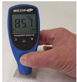
Для повышения точности рекомендуется выбирать на поверхности наиболее ровное место измерения с наименьшей шероховатостью покрытия, желательно на расстоянии более 1 см от края детали или внутреннего угла. Также перед измерениями рекомендуется выполнить калибровку нуля на образце без покрытия, аналогичном по материалу и толщине реальному изделию. Выполняйте несколько измерений в одной точке и усредняйте значение.
