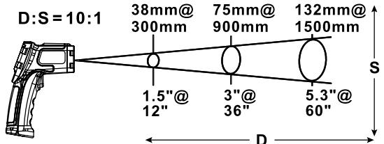
Диаметр пятна измерения напрямую зависит от расстояния до объекта, и является фиксированным отношением 10 : 1 т.е. если объект находится на расстоянии 10 см от прибора, то измеряемое пятно будет иметь диаметр 1 см, если на расстоянии 100 см, то измеряемое пятно будет диаметром 10 см и т.д., кроме этого нужно учитывать, что прибор показывает усреднённое значение по всему пятну измерения, и если размер объекта меньше диаметра пятна, будет ошибка в измерении.
