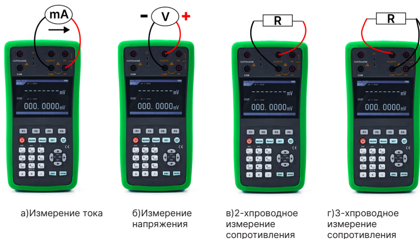
Рисунок 4 - Схемы подключения прибора в режиме измерения
