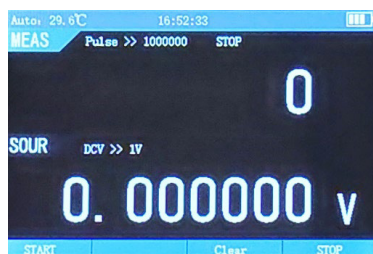
Рисунок 47 - Измерение «Pulse» (счетчик импульсов)
