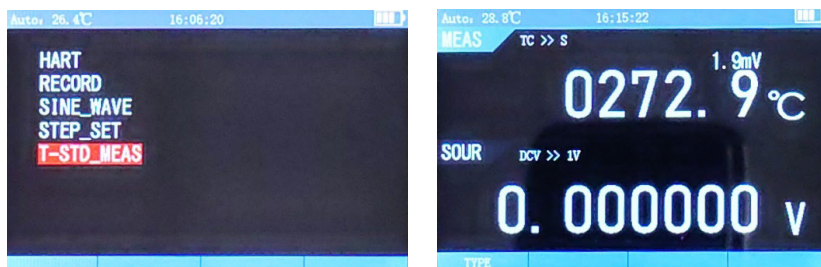
Рисунок 41 - Настройки стандартного измерения температуры
