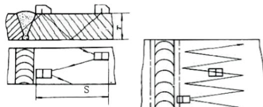
Рис. 34. Дефектоскопия сварных швов
