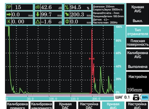
Рис. 50. Совмещение строба и эхосигнала, регулировка усиления
