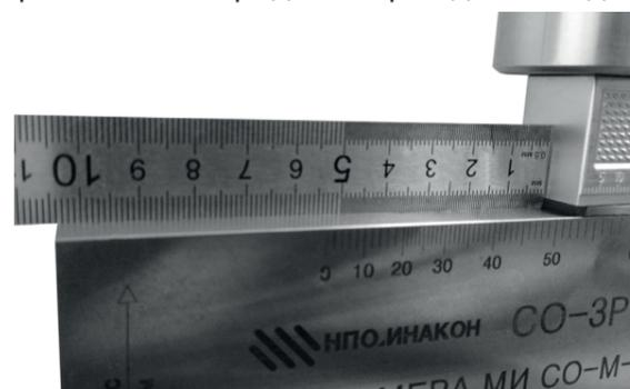
Рис. 17. Измерение передней кромки
