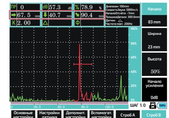
Рис. 32. Измерение, эхосигнал после настройки
