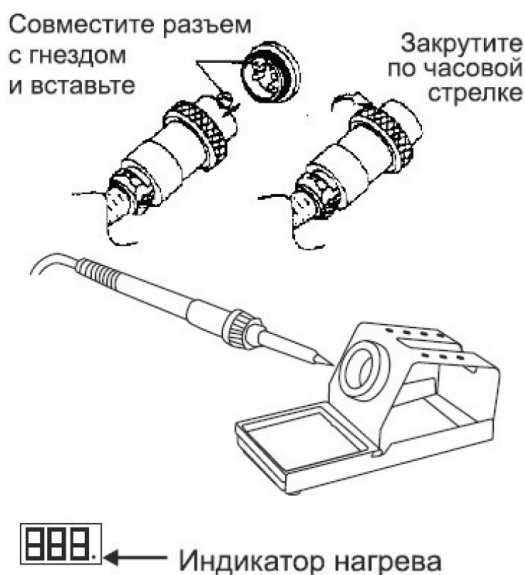
Рисунок 3 - Подключение паяльной станции
