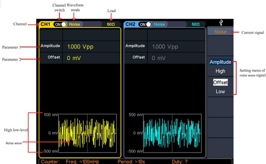
Рисунок 12 - Пользовательский интерфейс шумового сигнала
