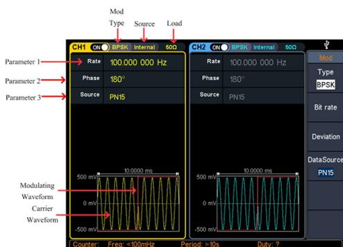
Рисунок 24 - Пользовательский интерфейс с двоичным фазовым сдвигом
