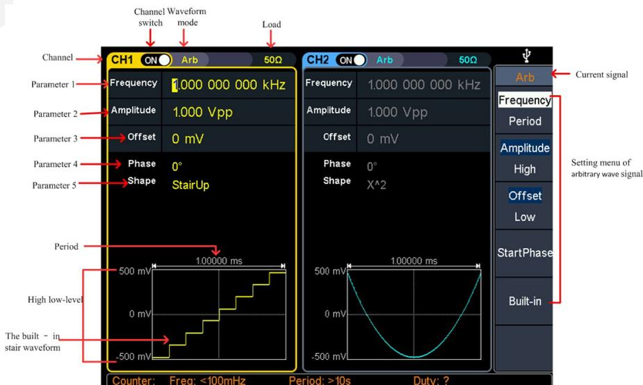
Рисунок 13 - Пользовательский интерфейс произвольного сигнала
