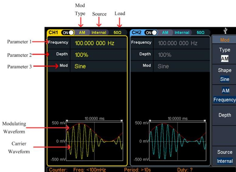
Рисунок 15 - Пользовательский интерфейс амплитудной модуляции
