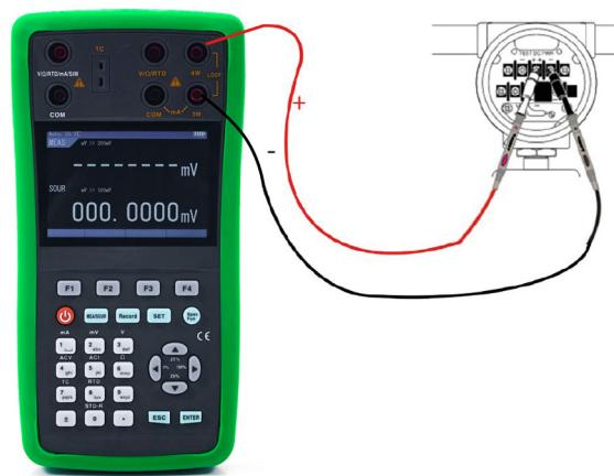
При измерении (и воспроизведении) сигнала с термопар прибор не только показывает значение выходного сигнала в градусах по встроенным калибровочным таблицам для термопар типа R,S,K,E,J,T,N,B, но и отображает э.д.с., генерируемое термопарой.
