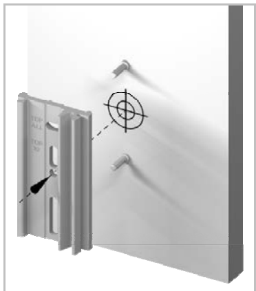
Базовая точка монтажной плиты
