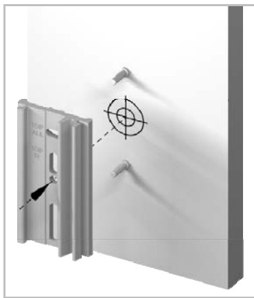
Позиция приваривания монтажной плиты
