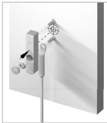
Позиция приваривания телеметрического датчика
