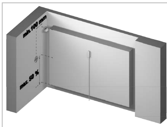
Позиция измерительного прибора при системе с 2 датчиками на стене в углу
