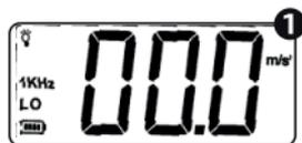
Нажмите кнопку выбора режима измерения <A/V/D>, при включении устанавливается режим измерения виброускорения, с низкой частотой (10 Гц ... 1 кГц), как показано на рисунке 1:
