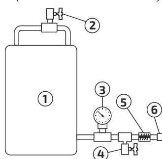
Подсоедините к насосу всасывающий и сливной шланги. На всасывающий шланг установите фильтры грубой и тонкой очистки (если жидкость для испытания чистая без взвеси и осадка - достаточно только фильтра тонкой очистки). Опустите всасывающий шланг в ёмкость с жидкостью для испытаний, а сливной закрепите над уровнем жидкости. Убедитесь, что сливной шланг не имеет перегибов.
