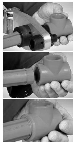
**5** Аккуратно извлеките трубу и фитинг из сварочного аппарата и вставьте трубу в фитинг. При стыковке не рекомендуется вращать их относительно друг-друга. Для обеспечения необходимой точности (угловые фитинги) рекомендуется воспользоваться дополнительной оснасткой.
